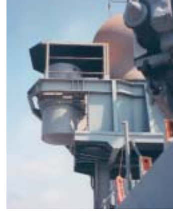
L'ARBB-36 de Thales qui équipe une frégate type Cassard . La guerre électronique prend une part de plus en plus importante dans la conduite des opérations navales. (Thales)
