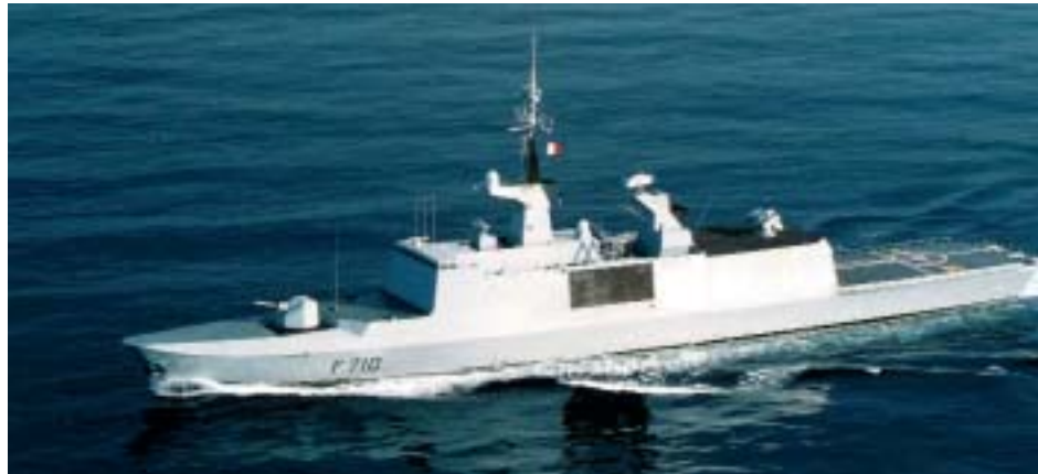
Une frégate française La Fayette . Sa signature radar serait équivalente à celle laissée par un chalutier. (Marine nationale)
