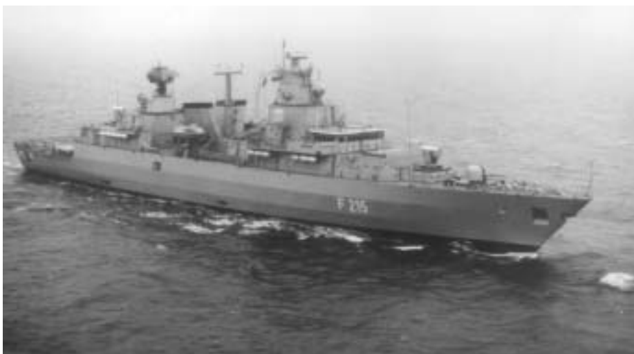
La frégate Brandenburg de la Bundesmarine. Ce bâtiment, lancé en 1994, dispose de silos Mk 41 capables de tirer 16 missiles Sea Sparrow.
