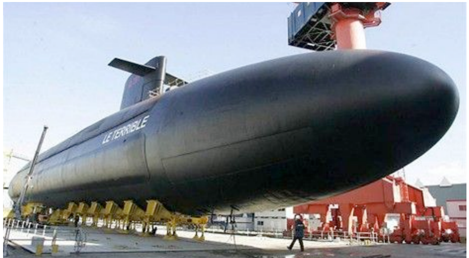
Le Terrible, sous-marin nucléaire lanceur d'engins de nouvelle génération, propulsé grâce à l'énergie produite par sa chaufferie nucléaire (crédit photo : DCNS)
